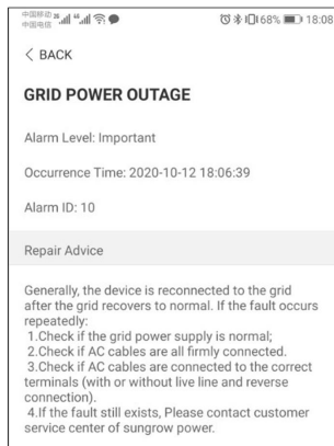
Rys. 7-8 Szczegółowa informacja o alarmie o usterce
